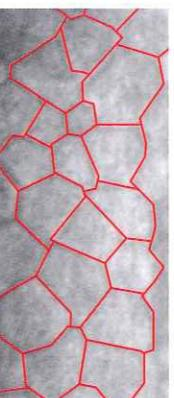
表示されている内皮細胞の輪郭をマニュアルでトレースし、その情報を元に解析を行います。
