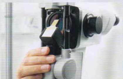
ミラーベース部だけを動かして、スリット光を容易に偏心
