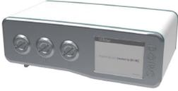
〈原理〉100V 商用電源を電源回路により降圧、整流し、発光ダイオードに通電する。発光ダイオードから強い光が発生し、光ファイバーケーブルにより光が術野に搬送される。
